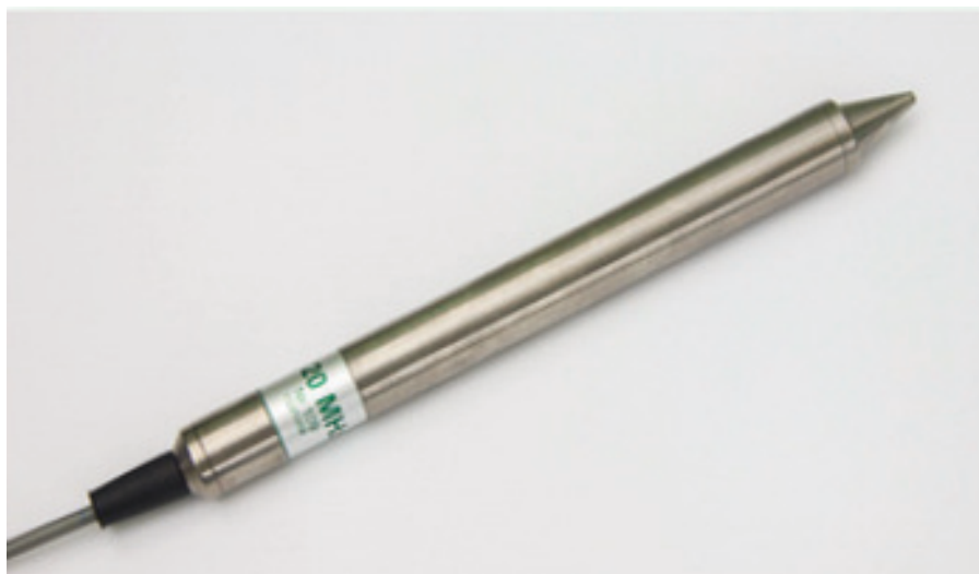
Рисунок 3 — Внешний вид датчика, применяемого в исследовании (20 МГц)
