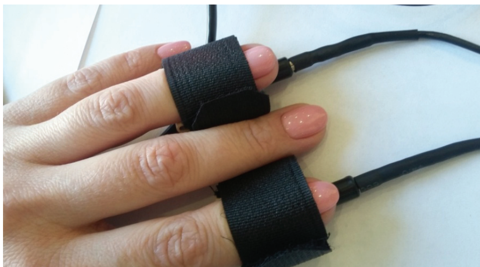
Рисунок 7 — Датчики регистрации кожно-гальванической реакции (КГР) для оценки эмоционального фона пациента
