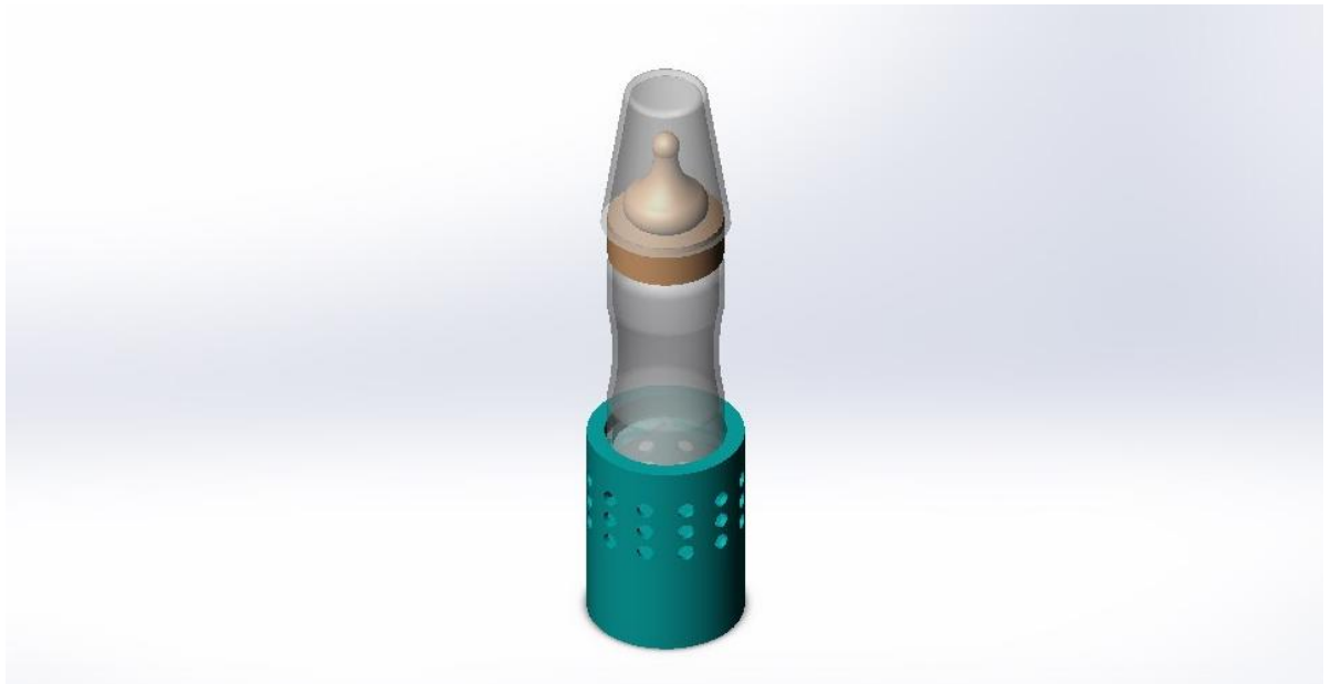
Рисунок 1 – 3D портативная модульная система для детского питания с терморегулятором и стерилизатором
