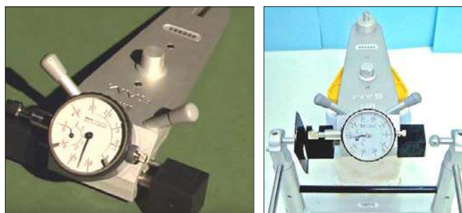
Рис. 1. Индикатор положения нижней челюсти (а), MPI установлен вместо верхней рамы артикулятора (б)
