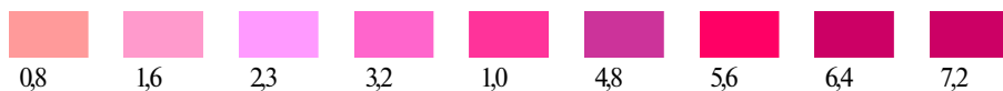
Рис. 6. Шкала цветности для определения фурацилина с ПАР и ионами марганца (II) в диапазоне концентраций (0,8–7,2) мг/л
